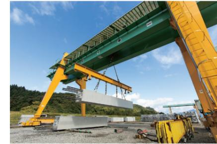
30tや20tの門型クレーンや、50tのクローラークレーンを配置することにより、大型で重量のあるPCa部材の製造が可能
